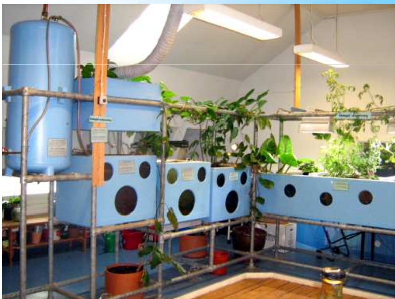
Model oczyszczalni ścieków
